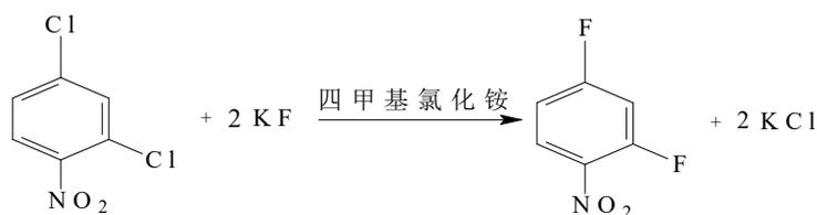
2,4-二氯硝基苯 氟化钾      2,4-二氟硝基苯 氯化钾
